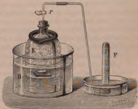
Fig. 87. — Préparation de l'azote par la combustion du phosphore.
